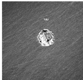
图 10 气孔缺陷的体视显微镜观测及尺寸测量图像
