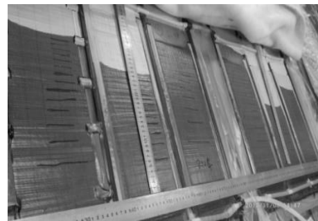
图2 不同织物结构参数下的织物树脂浸渍过程照片
