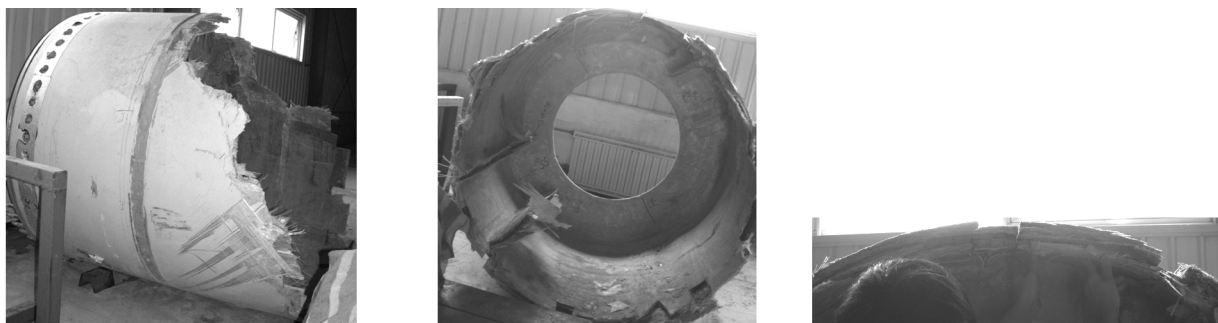
图 1 叶片断裂宏观形貌
