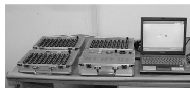
(d) 应变测试采集系统
