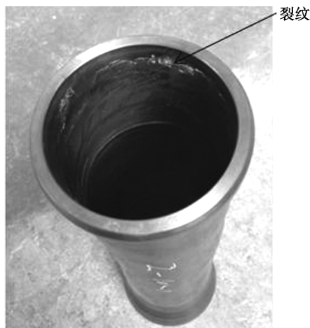
图4 出现裂纹的工件
