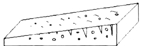
图 4 斜研剖面实验得出的工件简图
