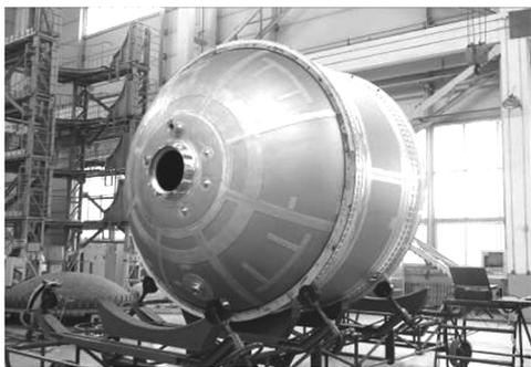
图 24 采用卧式总装方式研制的某型号  $\Phi 3$  350 mm 贮箱正式产品
