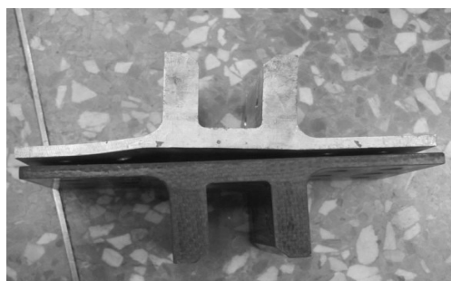
图 6 COM46 复合材料接头与 AL6 铝合金接头变形情况对比
