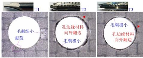
(a) 各钻型的制孔缺陷特点
