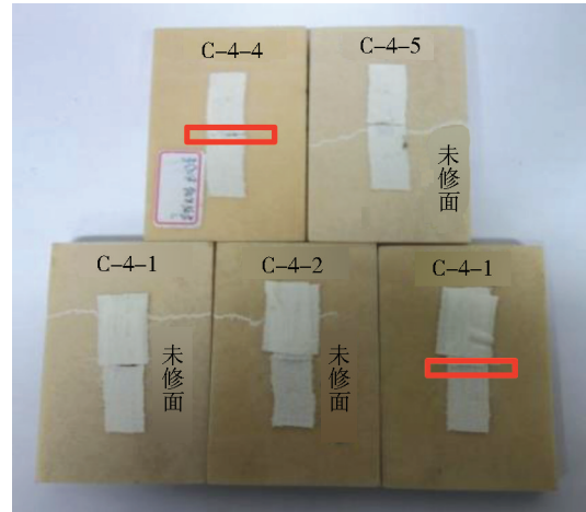
图5 维修结构面板破损位置图
