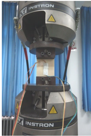
图3 维修结构的侧向压缩试验
