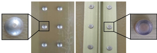
图11 GFRP/铝合金叠层压铆工程应用产品
