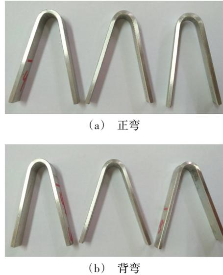
图 14 4 mm 的 FBFSW 接头的典型正弯和背弯测试结果
