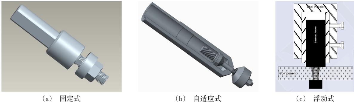
图1 双轴肩搅拌摩擦焊技术采用的三类焊接工具
