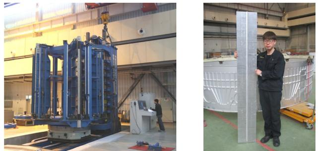
图 15 在立式纵缝 FSW 系统上进行长试片焊接验证
