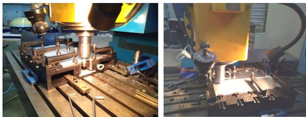
图 4 4 mm 厚 2219C10S 铝合金浮动式双轴肩搅拌摩擦焊接
