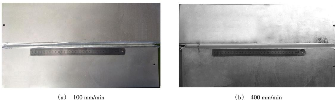
图8 两种焊接速度的焊缝成型效果
