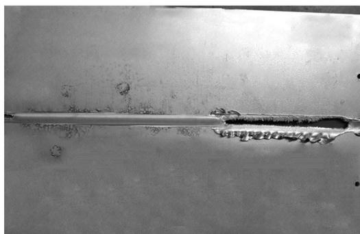
图 7 浮动式双轴肩搅拌摩擦焊接探索试验 2
