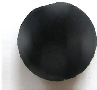
图5 氧乙炔烧蚀 30 s 后的泡沫碳表面宏观形貌
