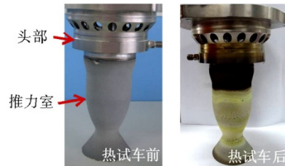
图4 490 N铱/铼推力室试车前后照片
