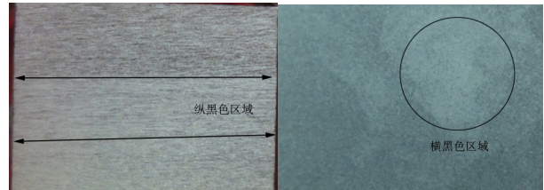
图7 低倍腐蚀后不同区域宏观形貌
