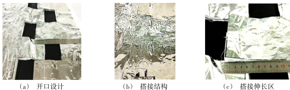
图3 开口设计、搭接结构及搭接伸长区
