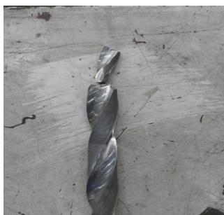
图 6  $35^\circ$ (螺旋角  $p$ )/ $15^\circ$ (后角  $\alpha$ )钻头加工后情况
