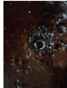
图 7  $25^\circ$ (螺旋角  $p$ )/ $15^\circ$ (后角  $\alpha$ )钻头加工切屑形式
