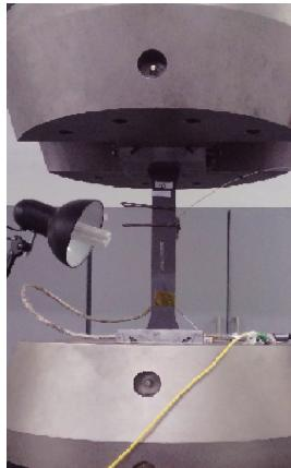
图3 安装有引伸计的试验件
