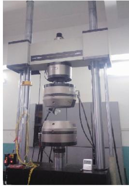
图2 INSTRON-8803型拉伸机
