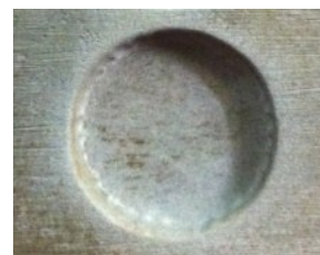
图 5 网状电极电解加工实验结果
